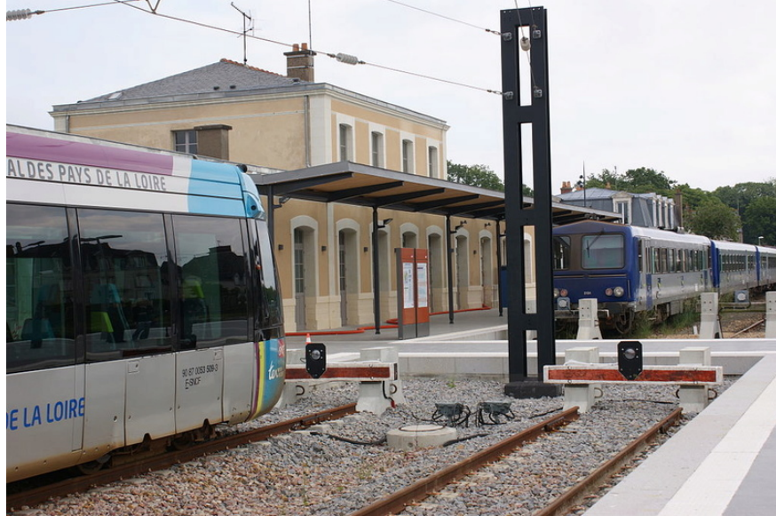
FIGURE 4.2 – À la gare de Châteaubriant, divers matériels roulants présentent des besoins électriques et de signalisation incompatibles, compromettant la liaison entre les régions de Nantes et Rennes.
