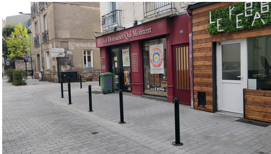
FIGURE 3.1 – Un trottoir au niveau de la chaussée : cette barrière prévient l'accès des voitures tout en garantissant une circulation fluide pour les piétons, y compris ceux à mobilité réduite, avec des poussettes ou accompagnés de jeunes enfants.
