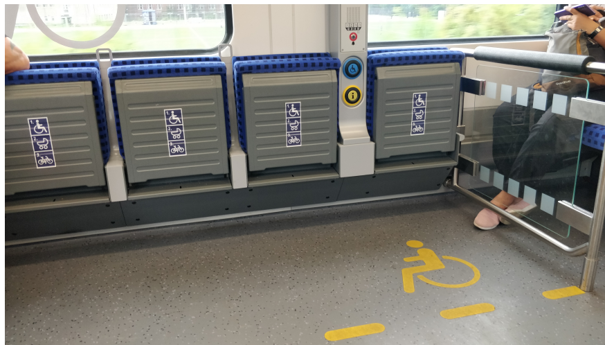
FIGURE 4.6 – Des sièges pliants et polyvalents à bord d'un train allemand, avec des indications de priorité pour les PMR, les mères avec jeunes enfants et les vélos. Rien ne nous empêche de proposer la même chose en car.
